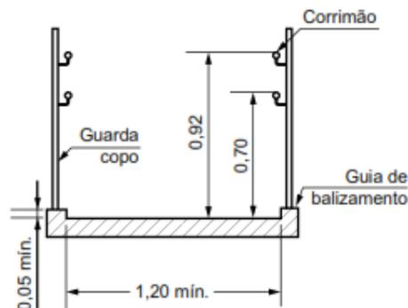
Os corrimãos podem ser acoplados aos guarda-corpos e devem ser construídos com materiais rígidos. Devem ser firmemente fixados às paredes ou às barras de suporte, garantindo condições seguras de utilização.
